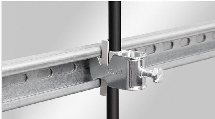
I morsetti di fissaggio sono caratterizzati da un'ampio campo di serraggio e da grande flessibilità. Ideale per garantire tenuta alla trazione su guida C con dimensioni di apertura 16-17 mm. Offre grande flessibilità di serraggio da 6 mm a 64 mm. La controparte è fissata da un meccanismo di bloccaggio e non può scivolare fuori dal serracavo.
